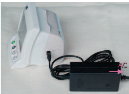
fot. 15 - Ładowarka do akumulatorów Ładowarka podłączana jest do modułu DentaPort Tri Auto ZX w sposób pokazany na zdjęciu, a następnie jest włączana do zasilania (AC - gniazdo z prądem).
