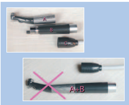
fot. 16 - Kątnica z mikrosilnikiem do Dentaport Tri Auto ZX. Końcówka składa się z dwóch elementów A i B. Element A (kątnica) może być sterylizowany w autoklawie, natomiast element B (mikrosilnik) nie, ponieważ zawiera w sobie różne wrażliwe komponenty elektroniczne. Komponenty te ulegną uszkodzeniu, jeżeli umieścimy w autoklawie oba elementy A i B.
