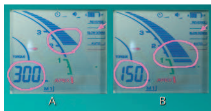
fot. 12 - Tryb Auto Apical Slow Down (strzałka) A - Głębokość kanału wynosi 2,0, a prędkość obrotowa mikrosiłnika 300 obr./min. B - Prędkość spada do 150 obr./min., gdy głębokość kanału osiąga wartość 1,0.
